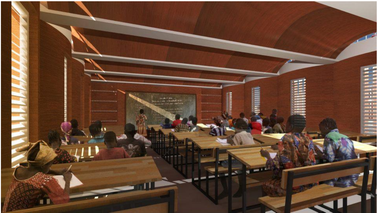
3. Im Inneren des Klassenraumes. Luft kann durch Kanäle unter der Erde hereinströmen um den Klassenraum zu kühlen.
